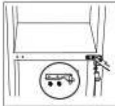
5. Mueva la cubierta del orificio de la bisagra de puerta inferior al otro lado. Luego levante la puerta inferior y colóquelo sobre un cojín suave para evitar arañazos.
